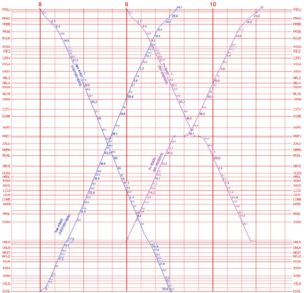
**Figure F.4** Train diagram of model freight trains on the line 526A + 527A/090, section Praha-Libeň – Děčín hlavní nádraží.
