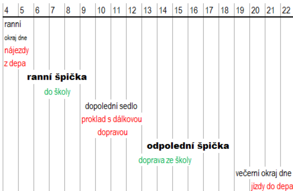
Obr. 1. Ilustrace příčin nepravidelností v ITJR během občanského dne (4 – 23 hodin). Černě jsou uvedeny obecné výkyvy poptávky, zeleně denní dojíždka žáků a studentů, červeně provozně-technologické příčiny [Zdroj: vlastní].
